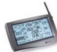
Betjeningsenheten plasseres innendørs og mottar alle værdata trådløst. Den har RS232 port og kan tilkoples PC.
